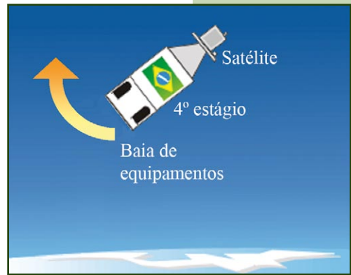
Figura 4.59. Manobra de basculamento do VLS-1.
