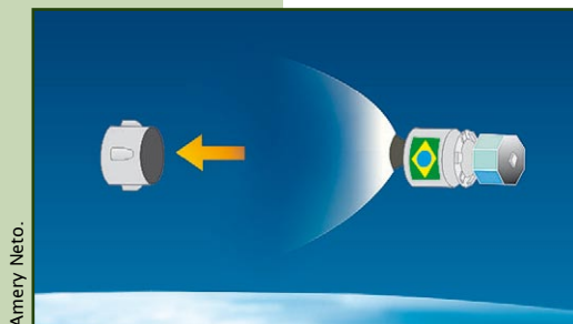
Figura 4.61. Separação da Baía de Equipamentos do VLS-1.
