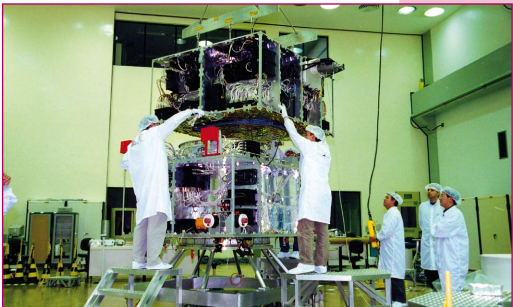
Figura 5.25. Cbers em fase de integração e testes no LIT.
