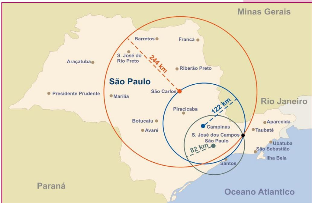
Figura 5.38. Princípio da trilateração em duas dimensões.
