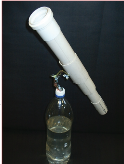
Figura 3.15. Montagem completa da luneta apoiada em seu "berço" e este preso no suporte do trilho de cortina.
